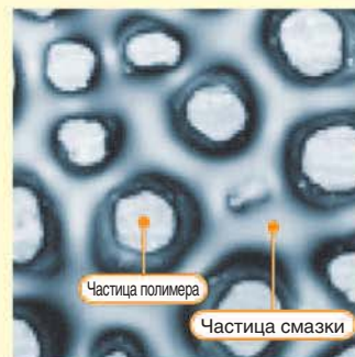
После пропитывания смазкой (Структура капиллярной смазки) Смазка удерживается в полостях между частицами полимера.
