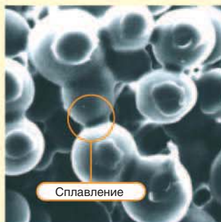
До пропитывания смазкой Соединенные сплавлением частицы полимера.
