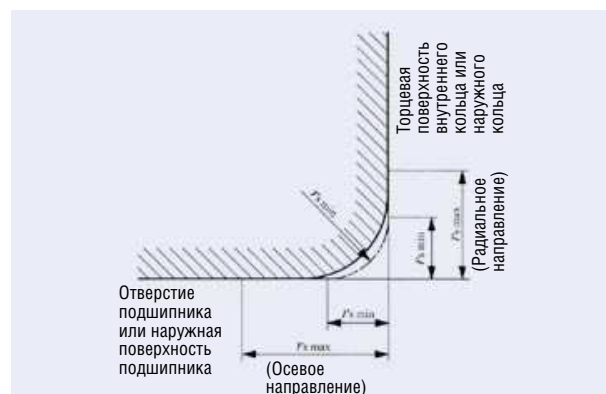
Рис. 12. Допустимые значения размеров фаски
