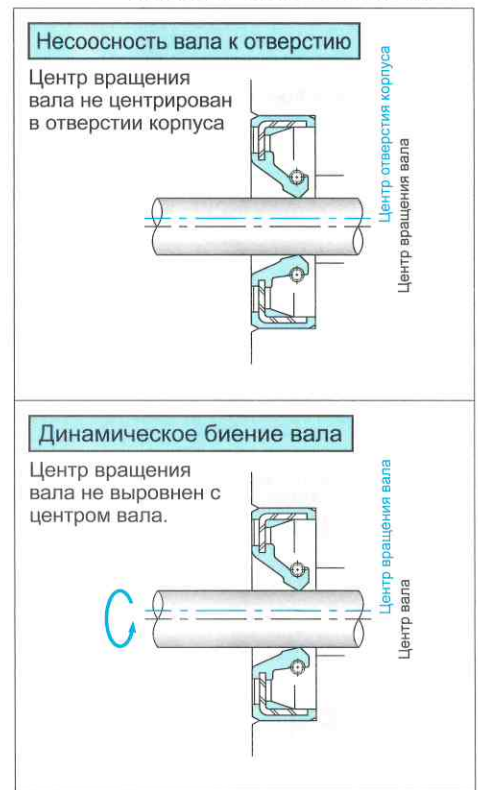
Рисунок 2: Несоосность вала к отверстию и Динамическое биение вала
