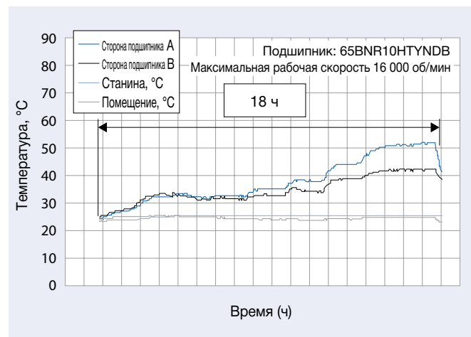
Рис. 3.1 Изменения температуры при работе с постоянной скоростью
