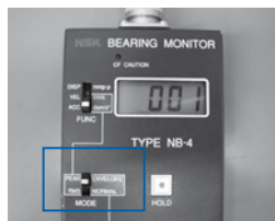
Записывание вибраций, вызванных царапиной внутри подшипника (ENVELOPE)
