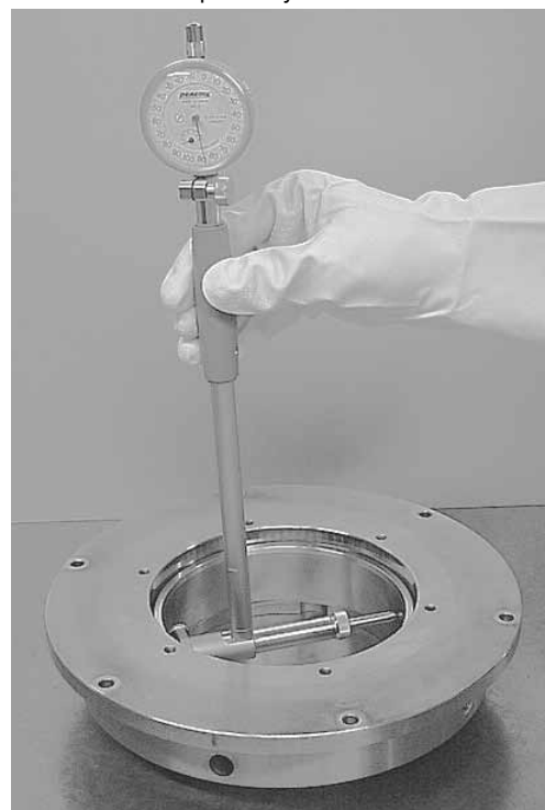
Рис. 1.11 Регулировка вписанного диаметра калибра GN
