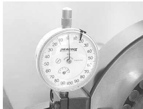
Рис. 1.15 Измерение ширины дистанционного кольца
