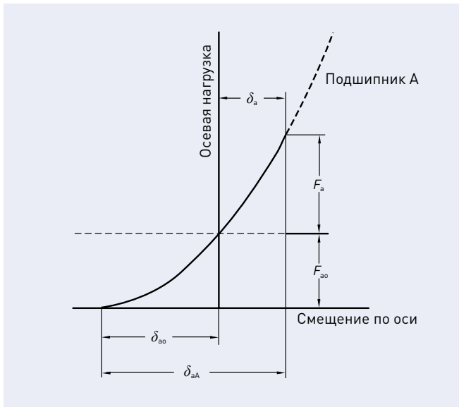
Рис. 4.8 Сравнение жесткости и преднатяга
